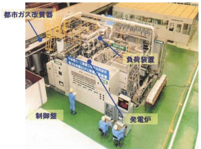
第7図 平板形SOFCとして世界最高出力達成
