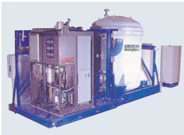
第9図 220kWシステム(シーメンス・ウエスチングハウス社)
