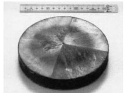
第17図 世界最大の超電導バルク体（直径15cm）
