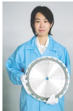
イットリウム系超電導線材(100m)
