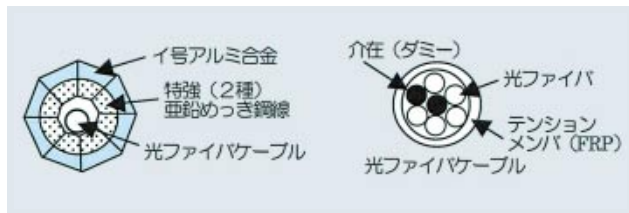
第1図 開発当初のOPGW 5心・外周テンションメンバタイプ例
