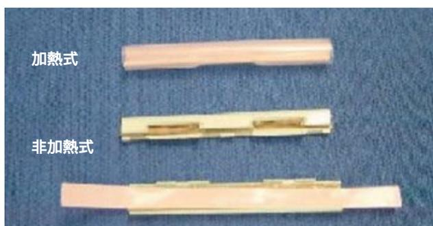
第7図 補強部材外観
