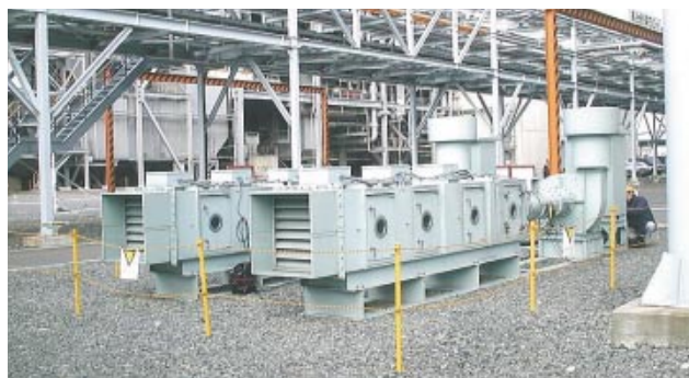
第11図 GT吸気フィルタ試験装置
