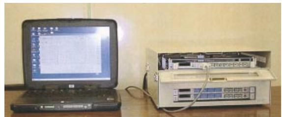
第1図 簡易型遠隔監視情報集約装置
