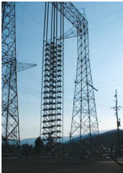
第4図 電力中央研究所 塩原実験場 (12MVインパルスジェネレーター)
