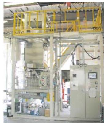
フロン・ハロン破壊処理装置
