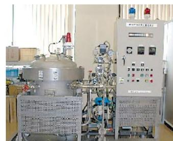
電磁誘導加熱式オートクレーブ
