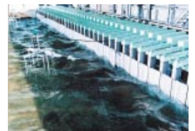
多方向不規則造波装置(スネーク式)
