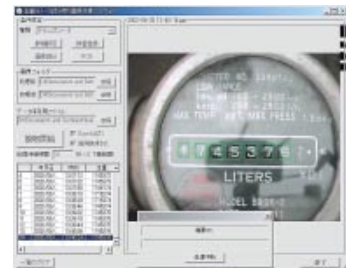
流量測定記録装置 (画像処理ソフト画面)
