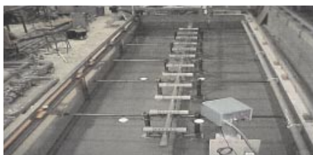
温度成層型蓄熱槽模型実験
