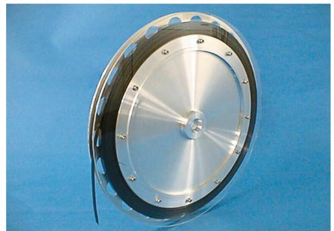
第5図 100m級イットリウム系超電導線材
