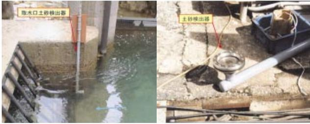
第2写真 土砂検出器設置状況 第3写真 土砂検出器
