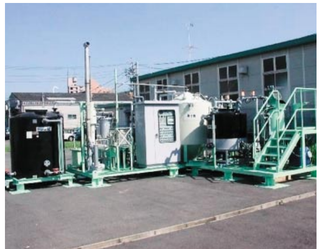
第2図 生ごみメタン発酵試験装置概観
