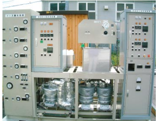
第3図 MCFC単セル試験装置概観
