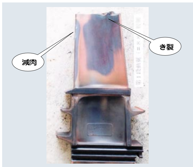
第1図 動翼の損傷
