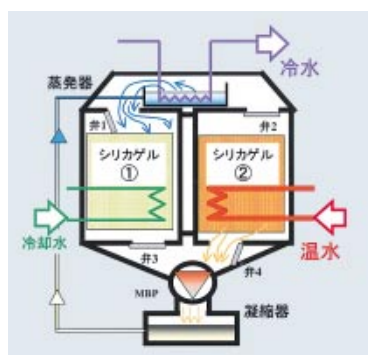
第1図 熱電駆動式吸着冷凍機の構成
