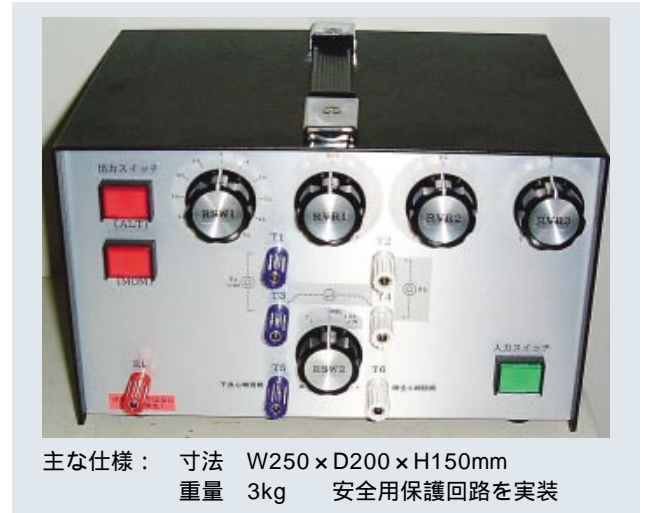
第5図 開発した故障点判定器
