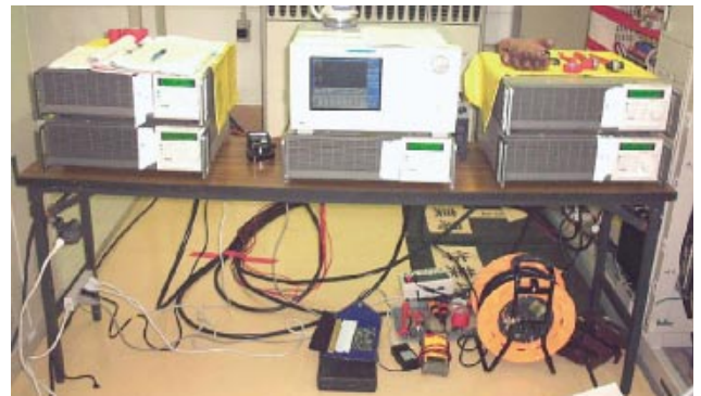
第2図 試験状況(電子負荷装置接続状況)
