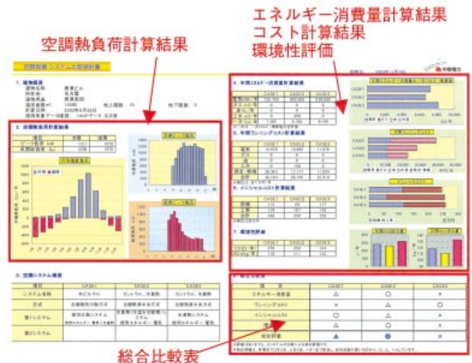
第16図 空調設備システム比較検討出力結果
