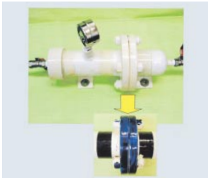
アンモニアによる変色状況
