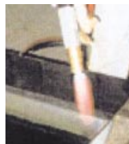
第2図 補修技術 溶射法)
