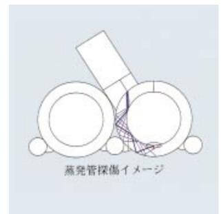
第5図 蒸発管探傷イメージ図
