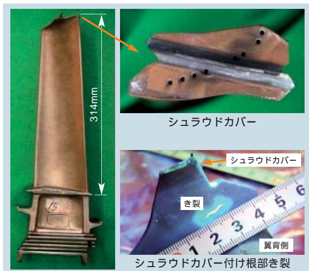
第1図 1300 級GT第2段動翼形状
