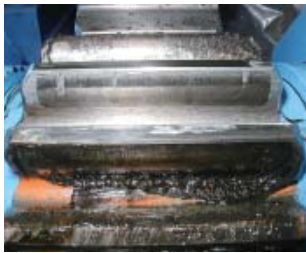
第3図 アブレーション摩耗の状態
