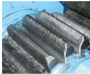
第4図 スコアリング摩耗の状態
