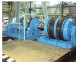
第1図 開閉装置モデル（ワイヤーロープ式巻上機）
