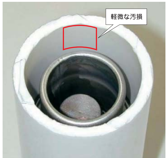
第6図 試験後の真空バルブ解体写真
