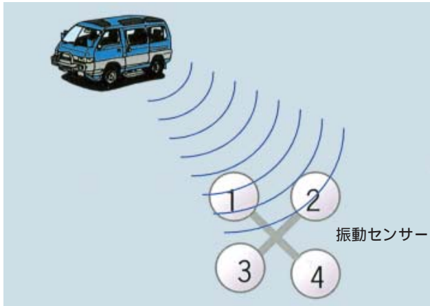
第4図 振動方向推定概要図
