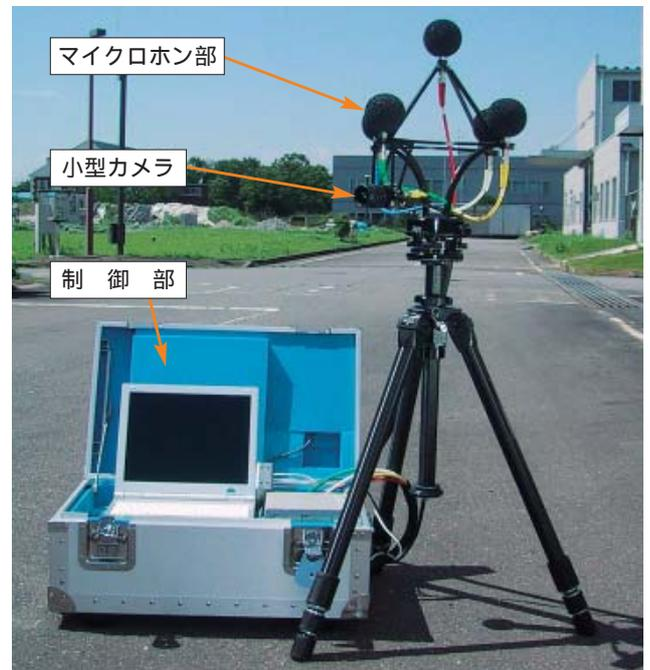
第1図 低周波音源探査装置 全体像
