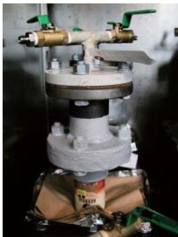
第3図 油密試験施工例
