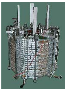
瞬低補償SMES用高温超電導コイル
