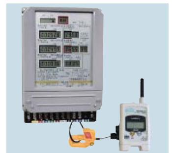
デマンド監視システム測定器
