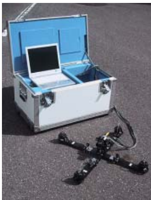
振動源探査装置(振動カメラ)
