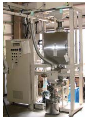
フッ素化合物破壊処理試験装置
