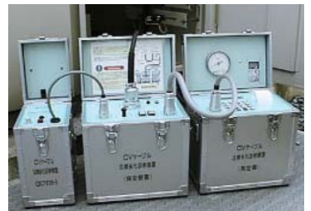
6kV級CVケーブル活線劣化診断装置
