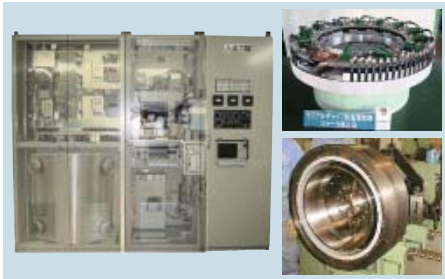
瞬低補償用フライホイールシステム 右上：ステータ 右下：ロータ
