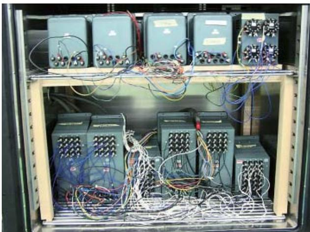
第3図 恒温槽での継電器単体加速試験状況
