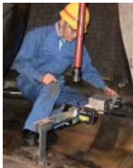
レーザー光を利用した石炭ミルテーブル摩耗量測定装置 (特許出願中)
