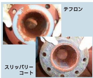
テフロンなみのスケール付着抑制効果と剥離性をもつ低コストなコーティング剤、スリッパリーコート (商標登録、特許出願中) の開発
