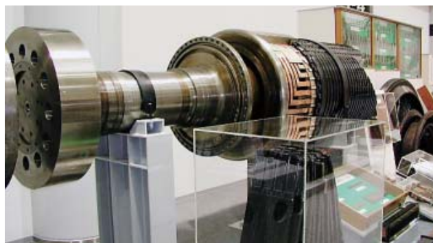
第10図 新名古屋火力220MW発電機回転子
