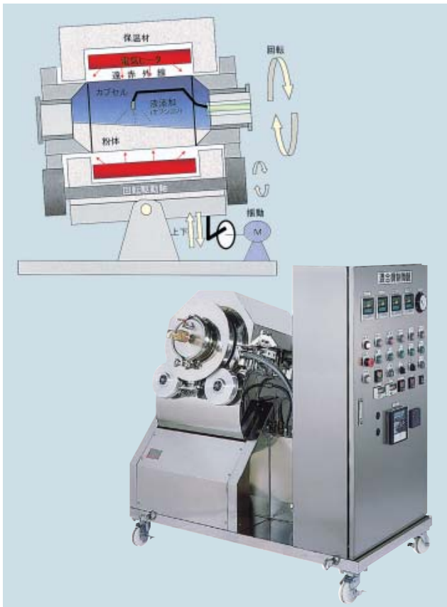
第1図 高温加熱ロッキングミキサの構成(上)と外観(下)
