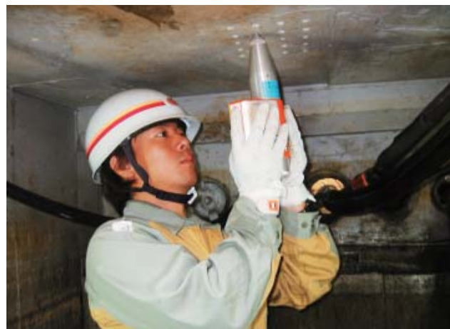
第15図 シュミットハンマによる測定状況
