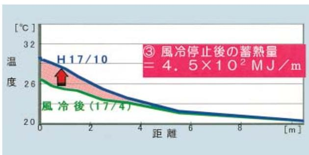
第5-2図 風冷停止後(非風冷時)熱収支実測結果
