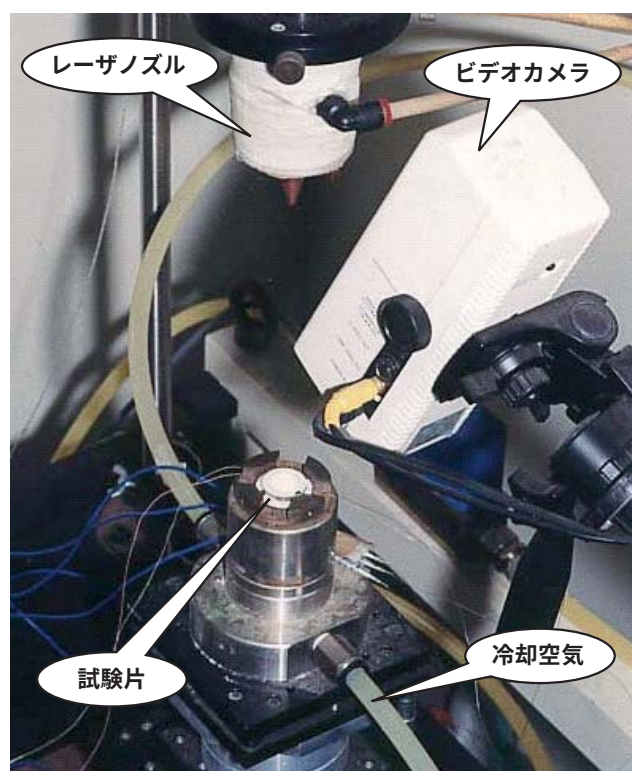
第4図 熱サイクル試験装置
