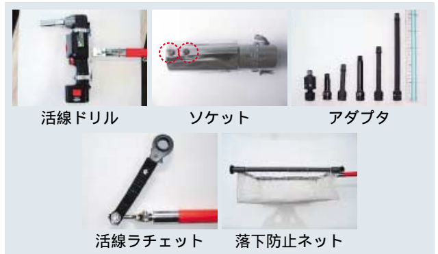
第2図 ボルト・ナット補修工具
