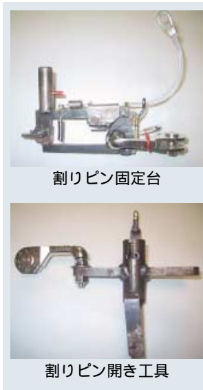
第3図 割りピン補修工具
