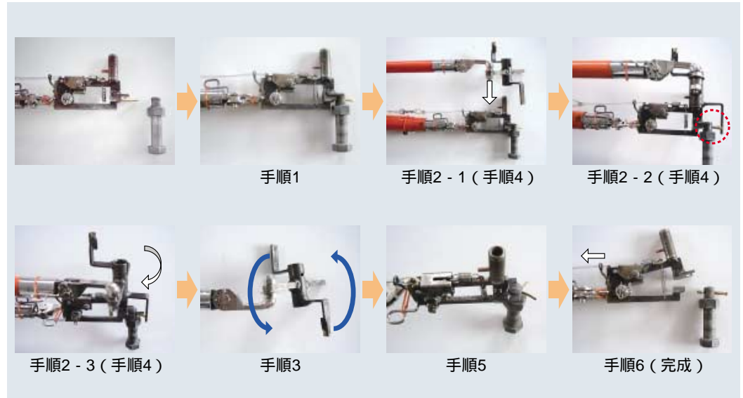
第4図 割りピン補修手順
