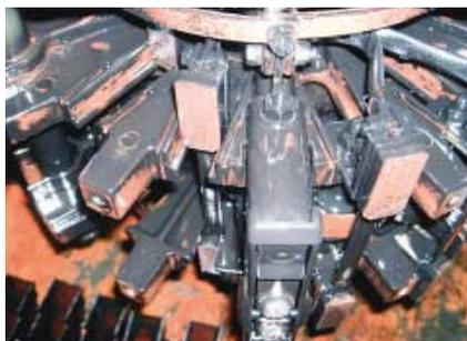
第4図 試験による機器へのスラッジ付着状況
