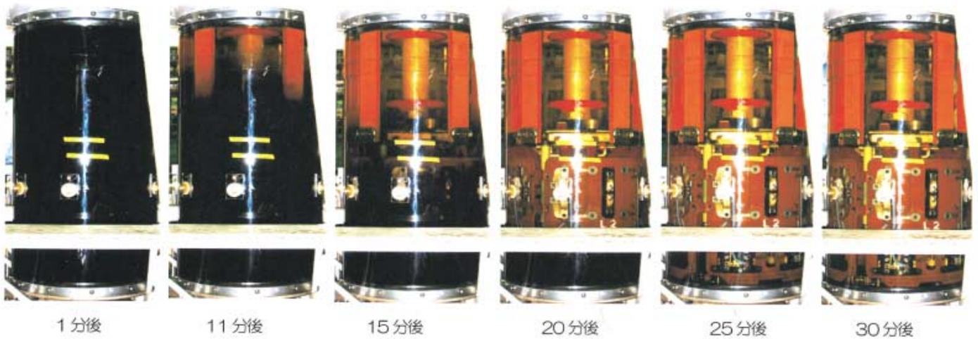
第2図 活線浄油機によるLR油槽室の清掃の推移(ヒーターON)
