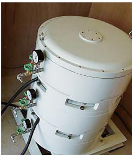
写真1 フライホイール電力貯蔵装置 (3台並列接続)
