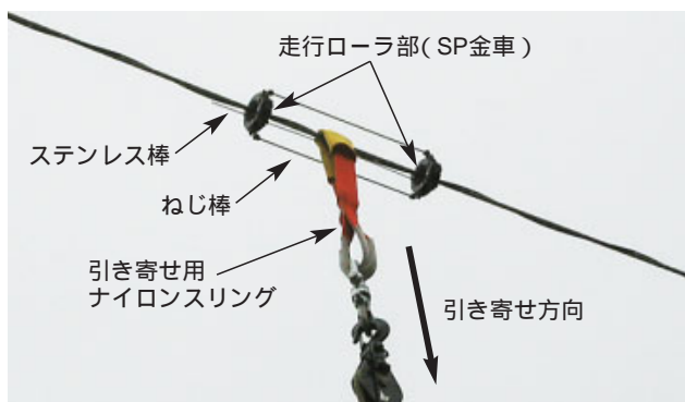
第4図 架空地線引き寄せ工具
