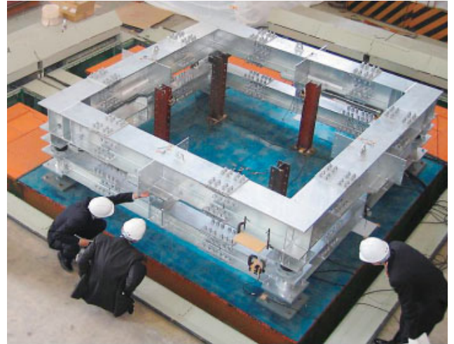
写真1 TMD加振実験状況
