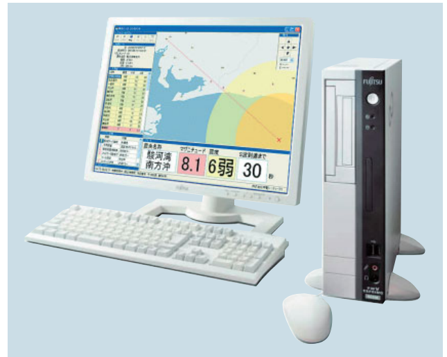
第4図 緊急地震速報受信装置
