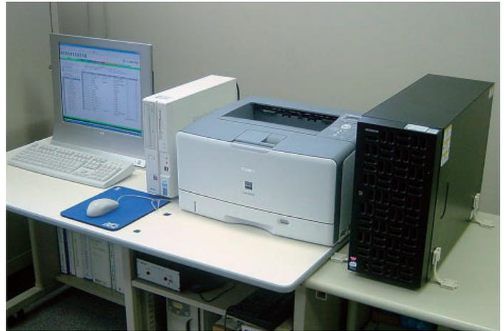
第2図 統合型系統動揺受信(解析)システム外観
