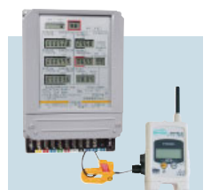
デマンド監視システム測定器
