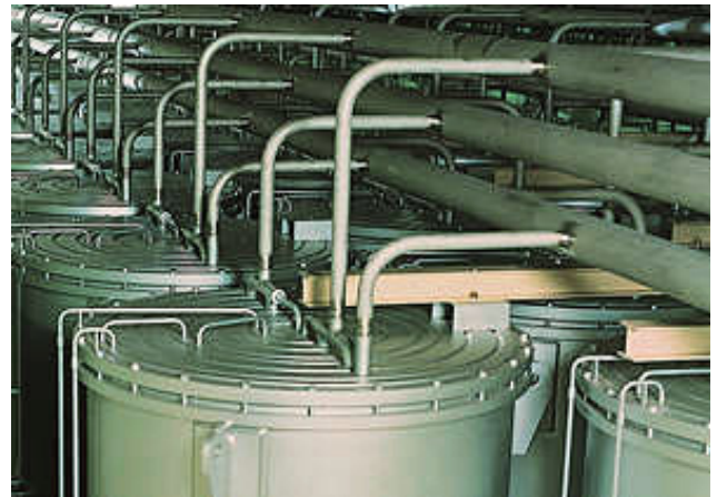
第5図 遠心分離機のカスケード例 2 (日本原燃)
