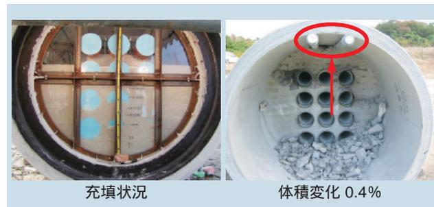
第5図 実規模試験状況写真
