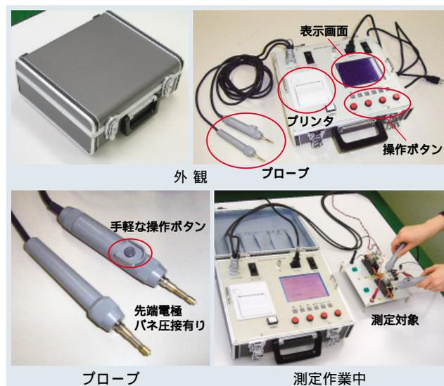
第3図 開発した接触抵抗測定器
