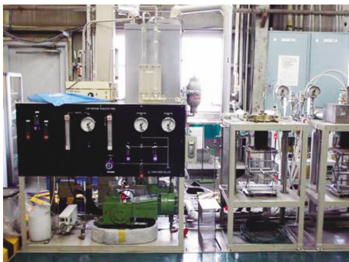
第1図 高温高圧水ループ試験装置 原子力発電プラントの水質環境を模擬して、配管材料等の試験を行っています。
