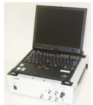
鉛蓄電池劣化診断装置(試作)
