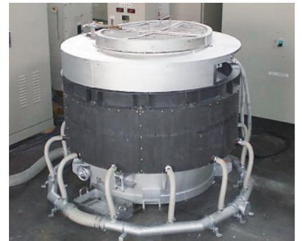
電気式アルミ溶湯保持炉
