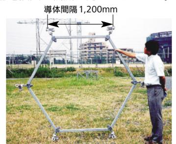
超大束径6導体スペース (500kV 越美幹線採用)
