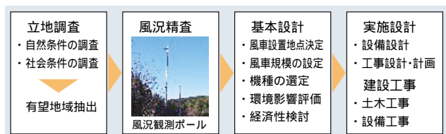
第1図 風力発電導入検討の流れ (参考：NEDO風力発電導入ガイドブック)
