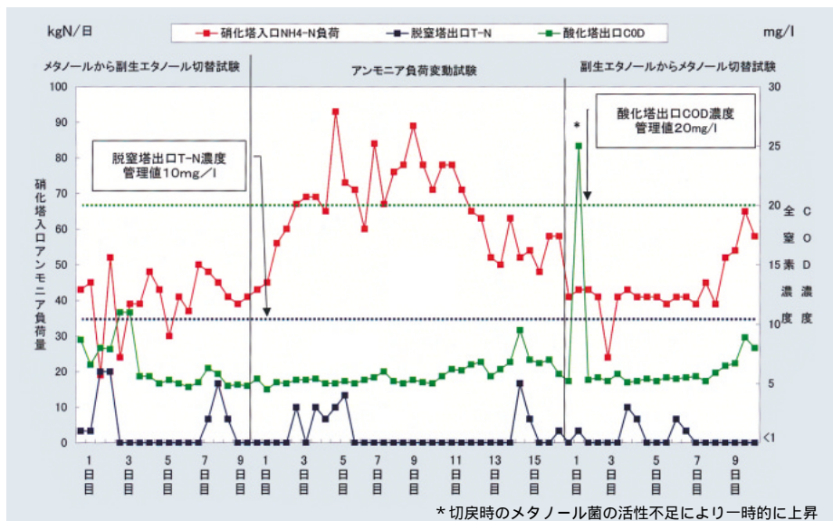
第4図 副生エタノール添加時の排水処理結果
