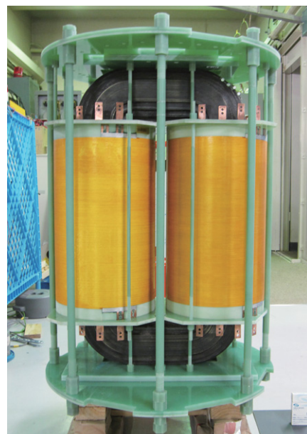
第1図 2MVA級高温超電導限流変圧器
